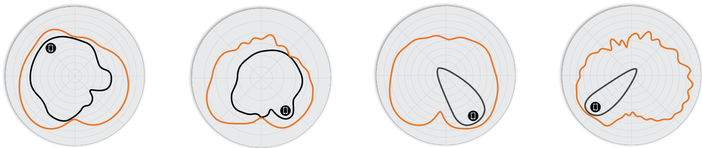
Figure 2. Diagrammes d'antennes Azimut R350 2,4 GHz Figure 3. Diagrammes d'antennes Azimut R350 5 GHz Figure 4. Diagrammes d'antennes Élévation R350 2,4 GHz Figure 5. Diagrammes d'antennes Élévation R350 5 GHz
