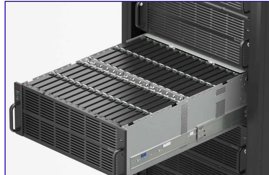
Le HD6500 s'ouvre via le haut du châssis
